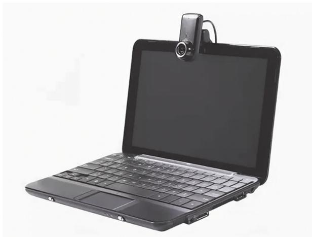
**Рис. 1.** Пример неудачной установки камеры (вибрация крышки ноутбука передается камере)
